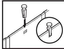
Para asegurar el deslizador superior del borde de ataque estilo T, coloque la pieza en forma de T dentro del borde de ataque y alinee los orificios. Después inserte la sección hembra del orificio exterior a través del orificio en el patín con forma de T a través del otro lado del borde delantero.
